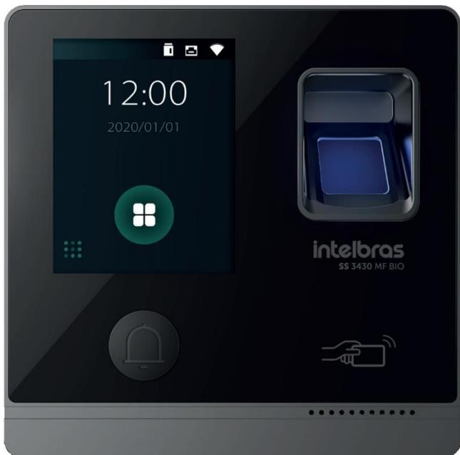
O SS 3430 BIO e o SS 3430 MF BIO são controladores de acesso com três métodos de autenticação: por senha (display *touch screen* capacitivo), leitura de cartão de proximidade (RFID) e biometria digital. Podem ser utilizados no modo *Stand alone*, com software de gerenciamento de controle de acesso ou com o módulo inteligente de portaria no modo MIP\*.
